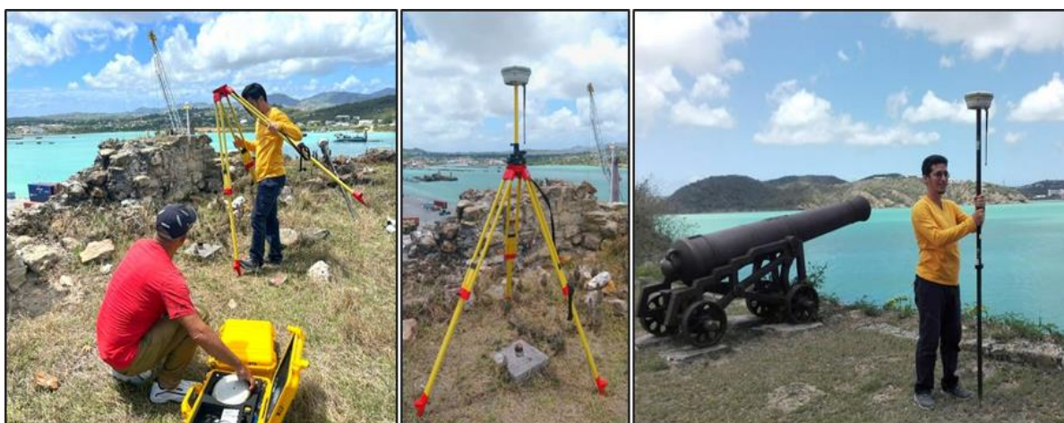
Fotograma 2: Levantamiento de Puntos de control desde el monumento topográfico en Rat Island, con coordenadas dadas por el Punto Focal, empleando un sistema de geoposicionamiento de alta precisión (GPS) con tecnología de movimiento en tiempo real (RTK).
