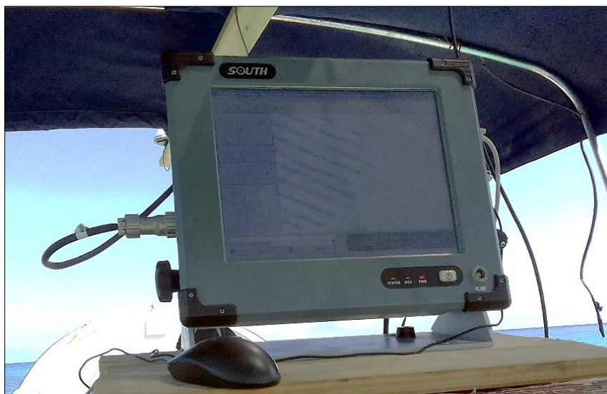
Foto 2: Ecosonda SDE-28S, instalada en el barco empleado para realizar el levantamiento batimétrico.
