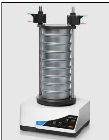
Foto 4: El tamizado de las muestras para el análisis granulométrico se realizó con un set de tamices pertenecientes a una tamizadora electrónica Retsch As 200.
