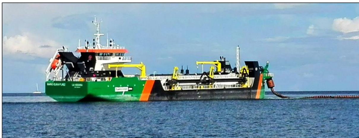
Foto 18: Ejemplo de embarcación con características idóneas para la ejecución del proyecto: Barco-draga Mario Oliva Pérez (Empresa Constructora de Obras Marítimas, Cuba); eslora 92.95 m, manga 16.5 m, capacidad en cántara de 3300 m 3 , calado máximo 6.20 m y potencia para bombear una mezcla de 1280 kg/m 3 hasta una distancia de 4500 m.
