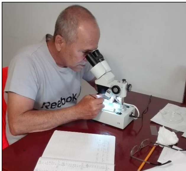
Foto 5: Análisis de muestras de arena al microscopio en el laboratorio de campo. Se realizaron análisis granulométricos y de composición de la arena de Runaway Bay y la zona de préstamo propuesta.
