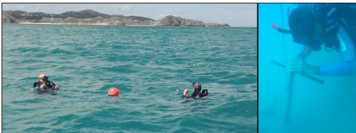
Fotograma 3: Exploración, perforación y muestreo del fondo marino mediante buceo autónomo.
