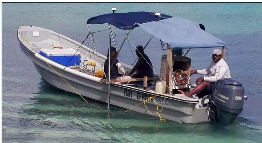
Foto 3: Estudio batimétrico del talud sumergido frente a la playa de Runaway Bay y zonas adyacentes, incluida la zona de préstamo propuesta; utilizando una ecosonda instalada en una pequeña embarcación rentada a un proveedor local.
