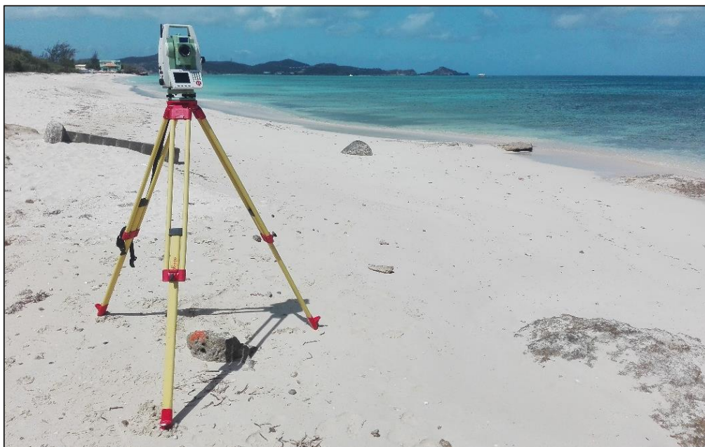
Foto 1: Una Estación Total Leica-TS09 fue igualmente usada en el levantamiento topográfico de la playa.
