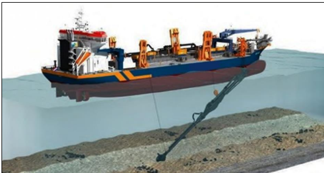
Figura 52: Representación de draga de succión en marcha en operación con brazo desplegado.
